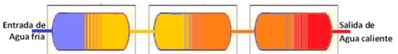
Fig.3. Calentadores compactos conectados en serie.
