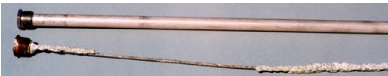
Fig. 21. Ánodo de magnesio (arriba nuevo, abajo agotado).
