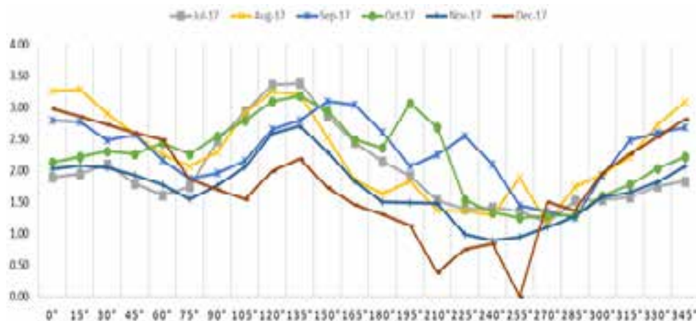
Fig. 7. Velocidades media por meses en dependencia del rumbo en el anemómetro No. 2.
