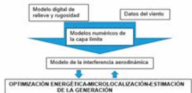
Fig. 2. Proceso para el proyecto de una instalación eólica: mapeo eólico y optimización de la configuración de las turbinas dentro del parque eólico. Fuente: Propia.
