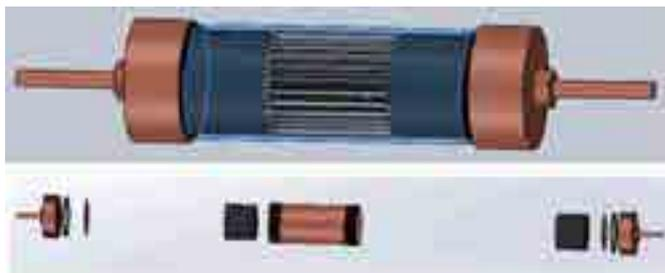
Fig. 7. Parallama o cortafuegos laberíntico.
