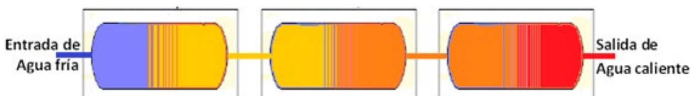
Fig.3. Calentadores compactos conectados en serie.
