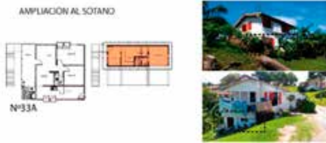
Fig. 6. Ampliación de las viviendas hacia el sótano.
