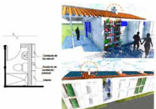
Fig. 15. Conductos de iluminación y ventilación natural en los edificios multifamiliares.
