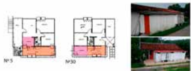
Fig. 4. Techado del patio de servicio y traslado de la cocina.
